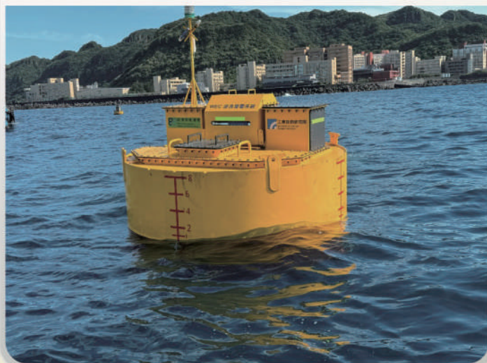
點吸收式波浪發電機組實海域測試
