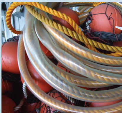
纜繩套上塑膠軟管以免摩擦破裂。
