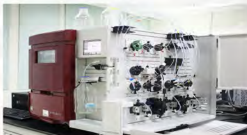
▲ 以蛋白質純化系統進行次單位疫苗或檢測用重組抗原之純化
