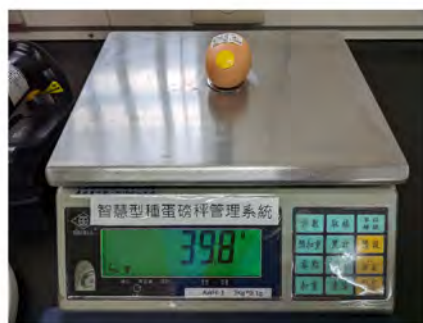
▲ 電子磅秤可將蛋重資料利用藍芽傳輸到系統中
