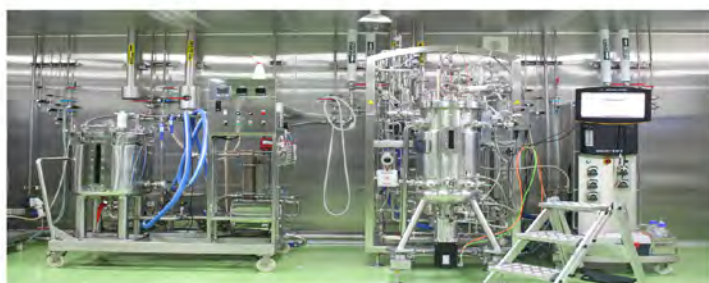
▲ 利用試量產發酵設備進行疫苗用種菌之高密度發酵培養
