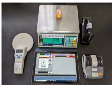
▲ 系統包含感應器、藍芽磅秤、平板電腦、掃描器及印表機
