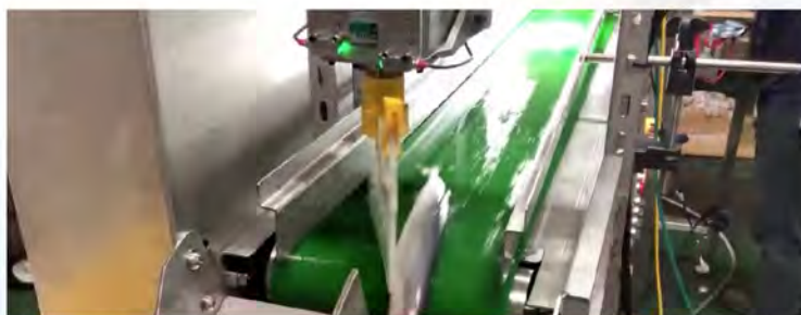
▲ 魚體自動化排整系統船上測試
