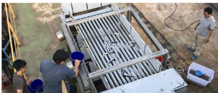
▲ 魚體自動化分級系統陸上測試
