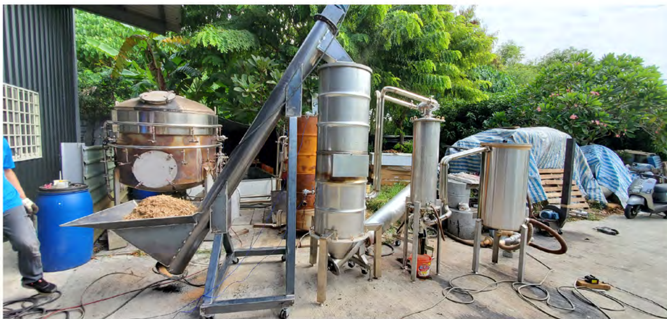
▲ 快速連續式炭化爐熱能回收系統
