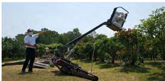
▲ 此履帶式高空作業車可在負載120公斤、舉升高度2.8米且傾斜角度 20^{\circ} 以內可保證安全
