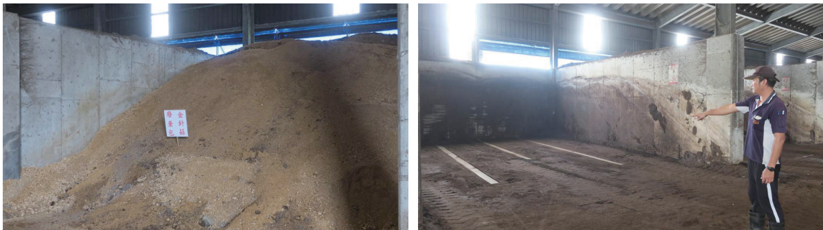
漢寶牧場將固態豬糞混入金針菇廢棄包，並埋設鼓風機管線抽風，將厭氧堆肥改為好氧堆肥，場內乾淨毫無異味。
