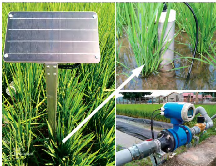
水稻灌溉程式模組技術， 利用智能運算連結田間即時水位與水門控制，實施精準灌溉
