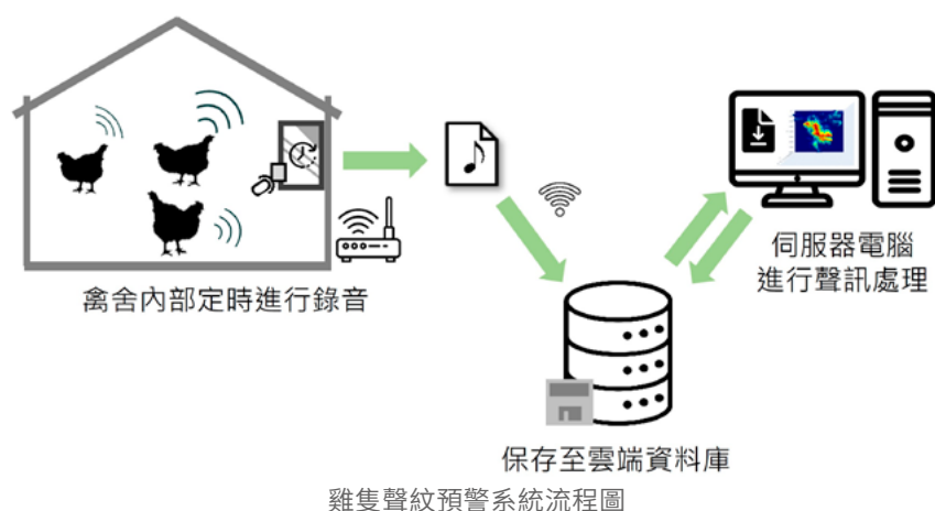
錄音設備由麥克風結合嵌入式系統安裝於禽舍內自行運行
