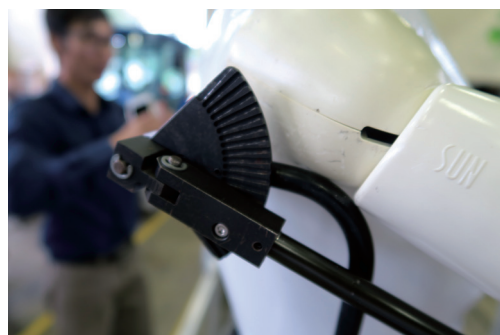
手臂作業輔助器具結構簡單不需使用電力。
