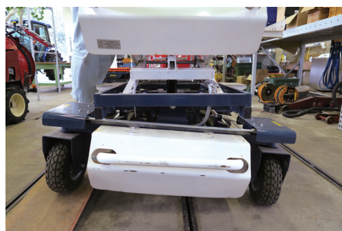
高空作業車模擬傾斜自動水平控制。
