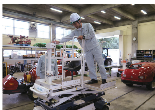
高空作業車具有突出板可延伸 50 公分，方便作業。
