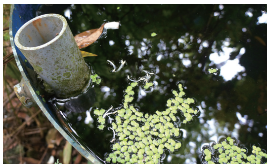
這是第三代的滅蚊蓄水容器，排水管裝在桶內就不會再被割草機給打到了。
