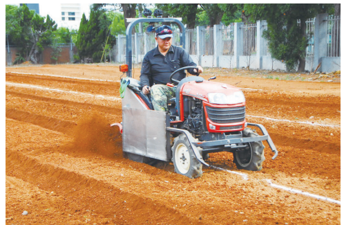
圖 4. 曳引機附掛開溝刀具以種植茶苗，亦用於蔬菜田間作業。
