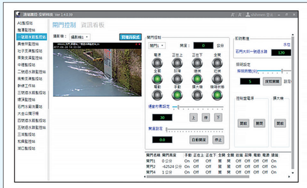
石門大圳自動測報系統閘門圖控平臺畫面。
