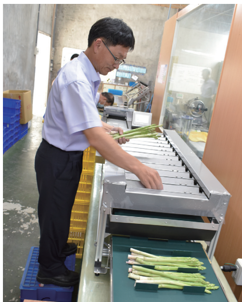
應用組合計量機可快速秤量，並組合成特定單束重量規格。
