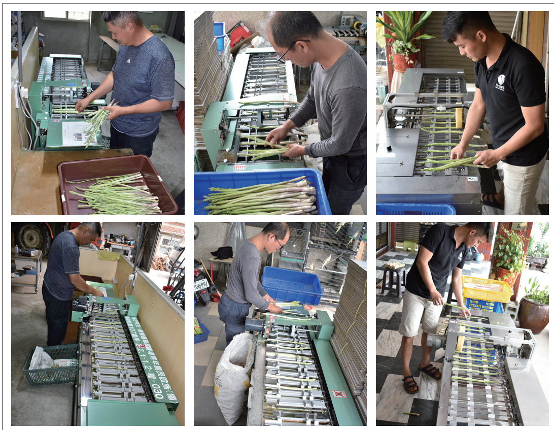
3位百大青農操作小型選別機之投放嫩莖作業（上排）與自動稱量分級實況（下排）。 （廠牌及機型依序為圖左：ORGIWARA-3n、圖中：ORGIWARA-3 修改版、圖右：NAVIC-777-TW。）
