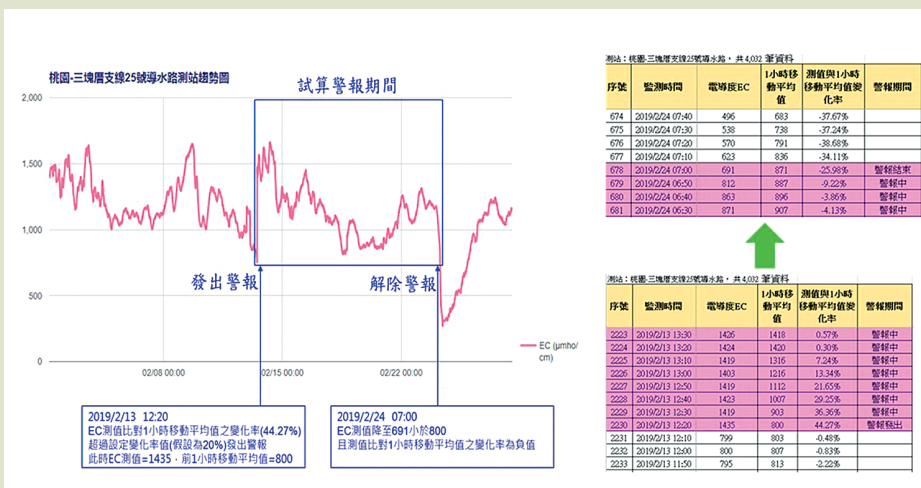
圖 5. 圳路型測站 EC 管理閾值設定案例。
