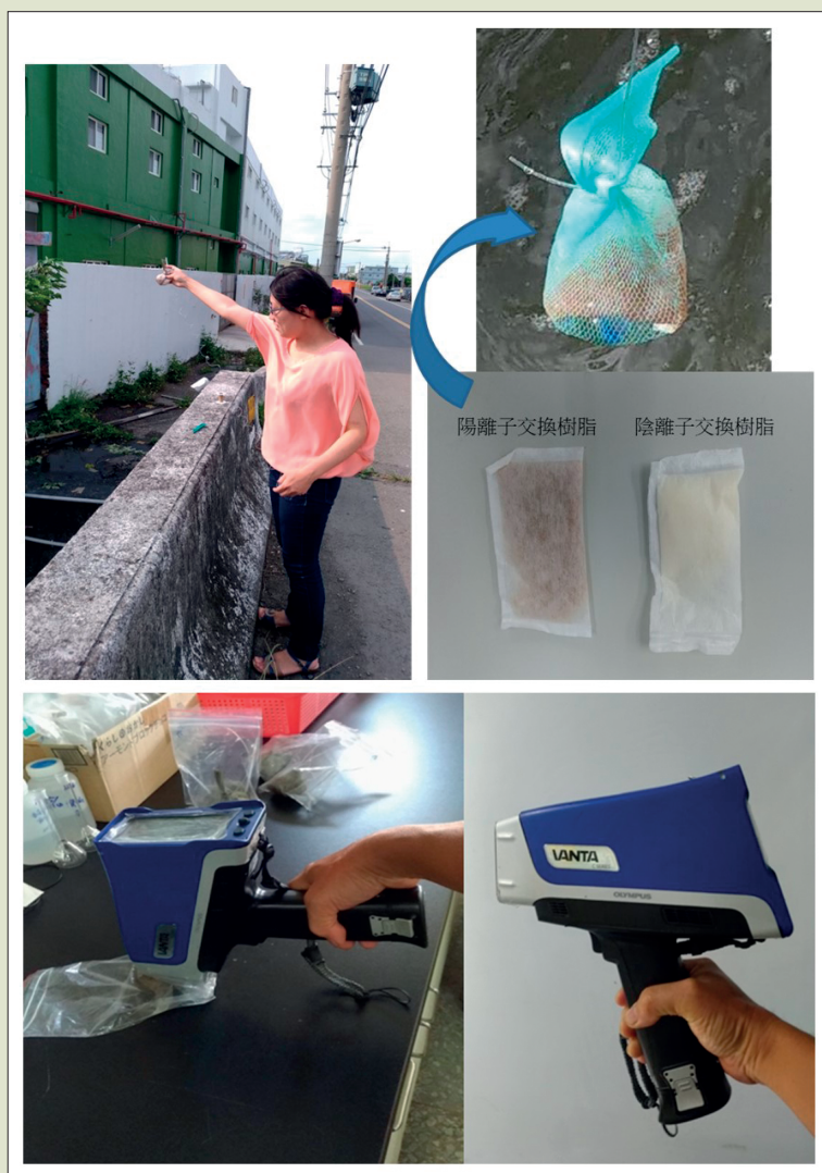
圖 8. 彰化水利會同仁現場布放樹脂縮時膠囊，回收後以 XRF 做檢測。
