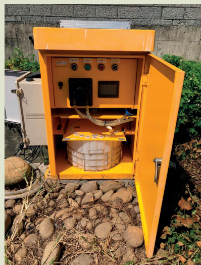
圖 3. 連續水質基本型自動監測站（桃園水利會埔心溪 25-7 號導水路測站）。
