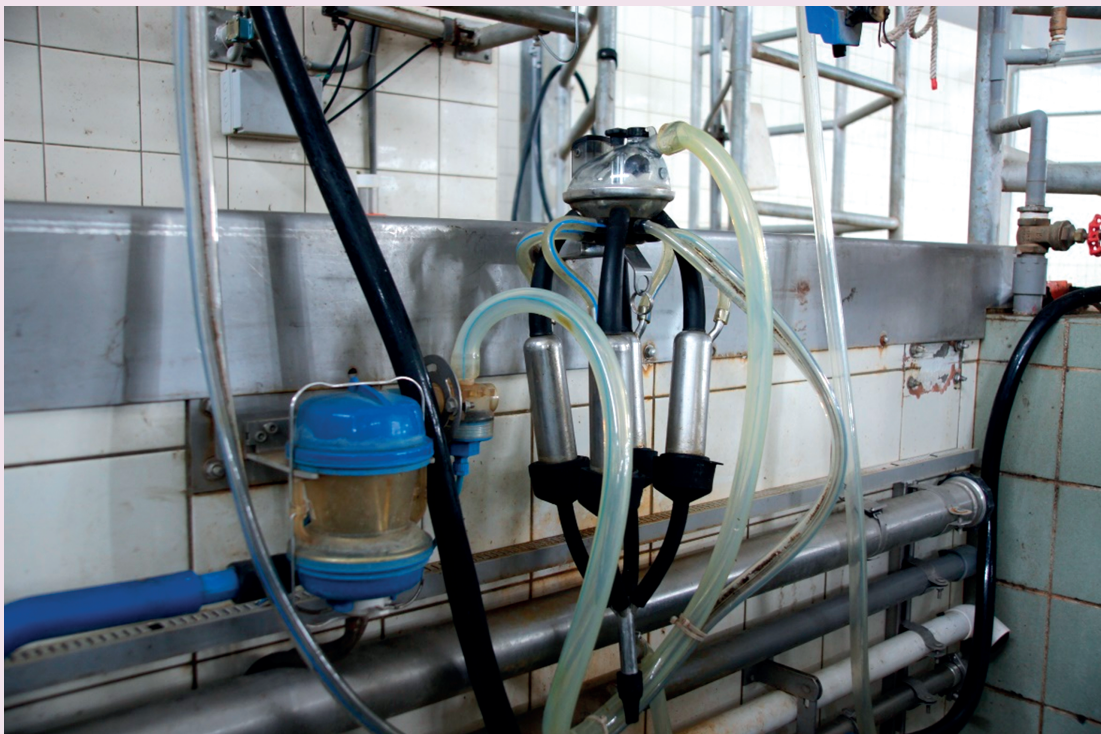
乳牛自動化擠乳系統之線上乳量計、導電度、體細胞數計量分級與乳杯自動脫落裝置。
