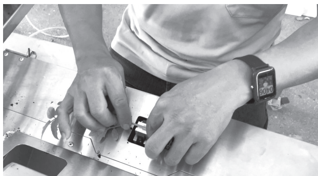
作業員提取穗砧苗進行靠接嫁接，由機具自動供應嫁接夾，並完成開夾、閉夾等多重功能，為機構設計中最困難處，成功開發完成是參與研發夥伴最受鼓舞及獲得滿滿成就歷程之處。
