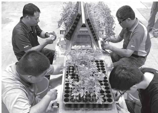
輸送帶嫁接輔助機具及4人分工作業情形，2員於輸送帶機前端進行苗株斜切作業，2員於後端進行苗株嫁接接合作業。
