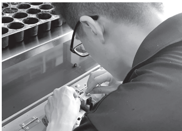
作業員使用輸送帶嫁接輔助機具進行苗株嫁接接合的操作情形，把斜切完成的穗砧苗進行切口面靠接，機器自動閉夾完成嫁接工作，人員無須拿刀及夾子，省工、省力又簡單。
