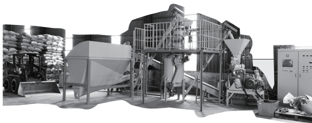
圖 5. 畜試所研發之雞糞加值產品處理套組。
