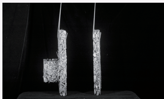
圖 4. 組合式綠竹板（袋式綠竹板）（左）及平面綠竹板（右）側面照。
