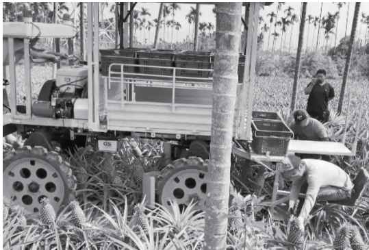
圖8. 鳳梨多功能管理機採收作業情形。
