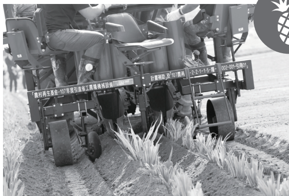
圖3. 巴西進口附掛式鳳梨種植機作業情形。
