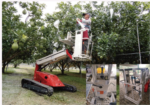
圖2. 南改場於107年引進之日本汽油履帶式吊桿高空作業車。
