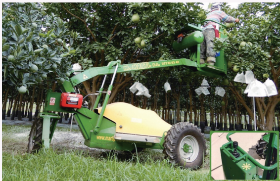
圖1. 南改場於106年引進之西班牙柴油輪式吊桿高空作業車。
