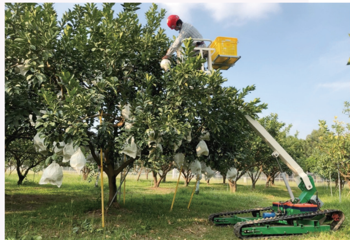
圖5. 應用於果樹採收、修剪、疏梢、套袋等作業可較傳統攀爬或架梯作業方式提升效率50%以上。
