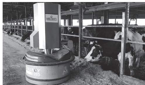
圖3. 推料暨餵精料機器人具有2個精料桶，各可裝填70公升精料容量，其香氣足以吸引牛隻前來吃草。
