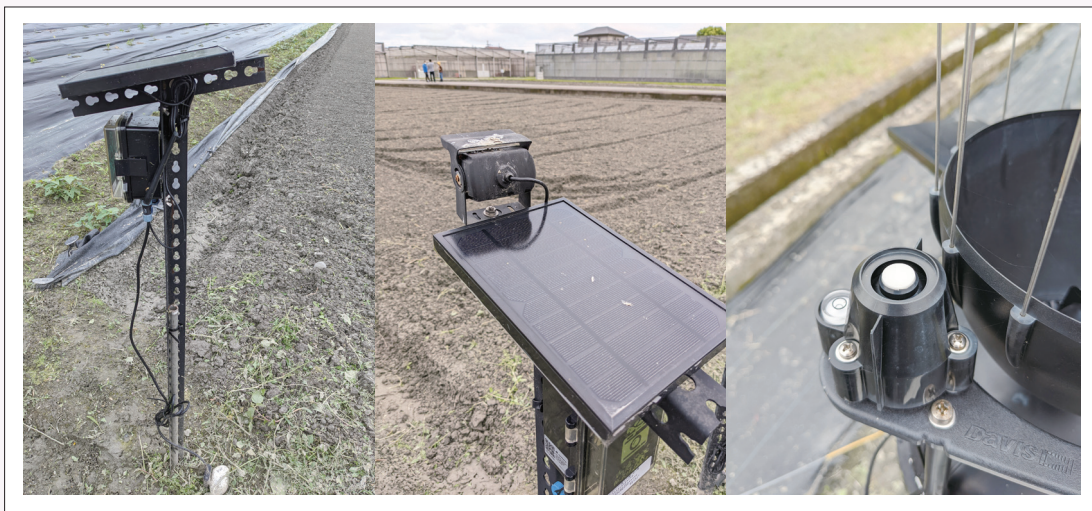
土壤感測器 (左)、田間攝影 (中)、光強度感測 (右)。
