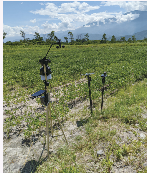
田間監測設備（含氣象站、土壤感測器及田間攝影機），是蒐集數據的重要幫手。
