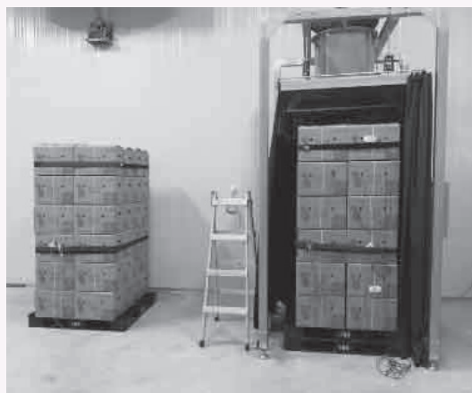
圖9. 農委會高雄區農業改良場進行外銷鳳梨裝箱裝棧板後頂吸式壓差預冷之測試。
