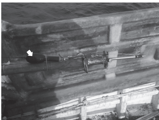
圖3. 將彈脫型衛星標識記錄器 (PSAT) (箭頭標示處) 配置於鏢桿上。
