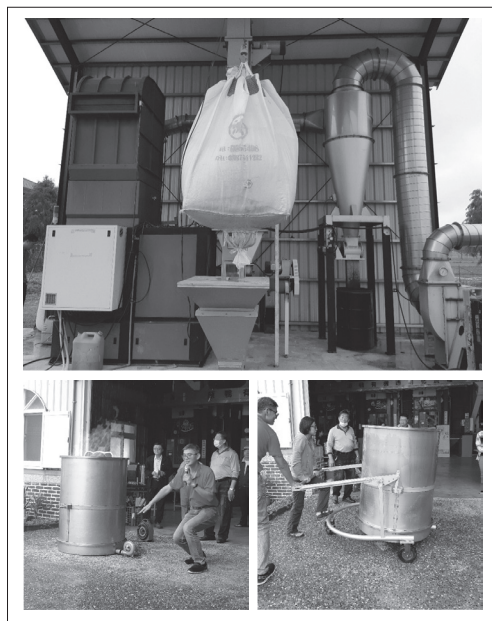
宜蘭三星原鴨有機米廠——稻殼炭連續燃糠爐產炭技術示範場域。上圖為連續式產炭燃糠爐，左下及右下圖為可單人操作之批次式通氣小型碳化設備。
