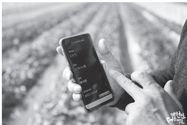
在草莓溫室農場使用傳感器節點搜集作物的室內和室外生長和環境數據，將訊息傳送到手機，利用多個溫室單元控制器來管理農場。
