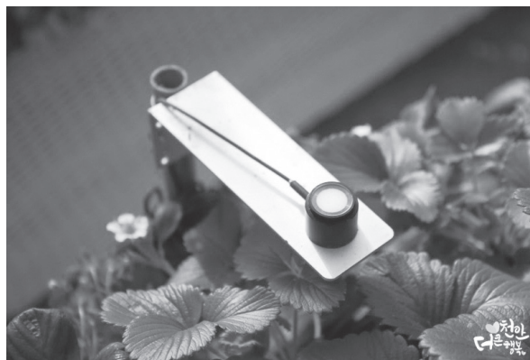
在草莓溫室農場使用傳感器節點搜集作物的室內和室外生長和環境數據，將訊息傳送到手機，利用多個溫室單元控制器來管理農場。
