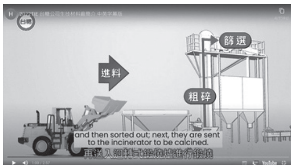
國營會展出「台糖生技材料廠」線上展影片中廢棄牡蠣殼製成碳酸鈣之處理流程。
