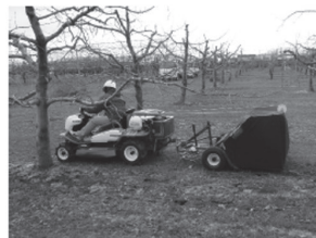
今回開発した収集機の外観 乗用型草刈機けん引による作業の様子
