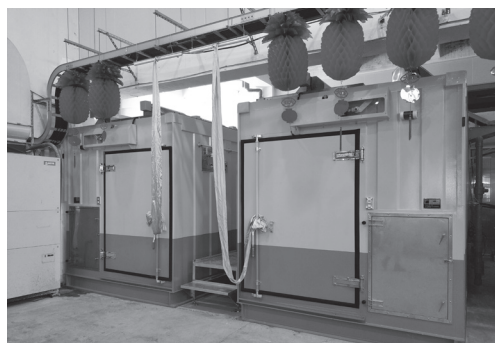
輔導臺南市政府更新玉井蒸熱處理場蒸熱設備，預估芒果處理良率可接近100%。
