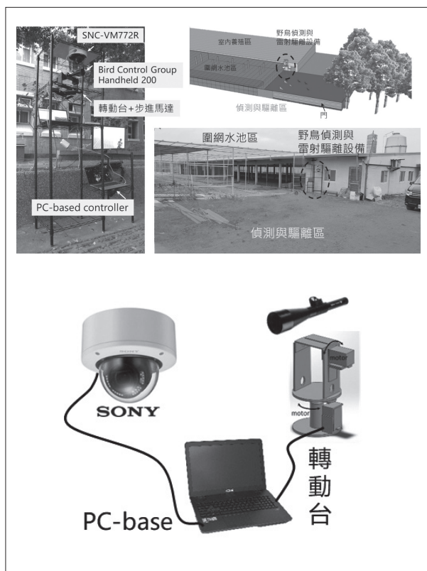
圖2. 由攝影機偵測場域，經由電腦辨識野鳥後傳輸位置使轉動台轉動並連動雷射槍進行驅鳥。
