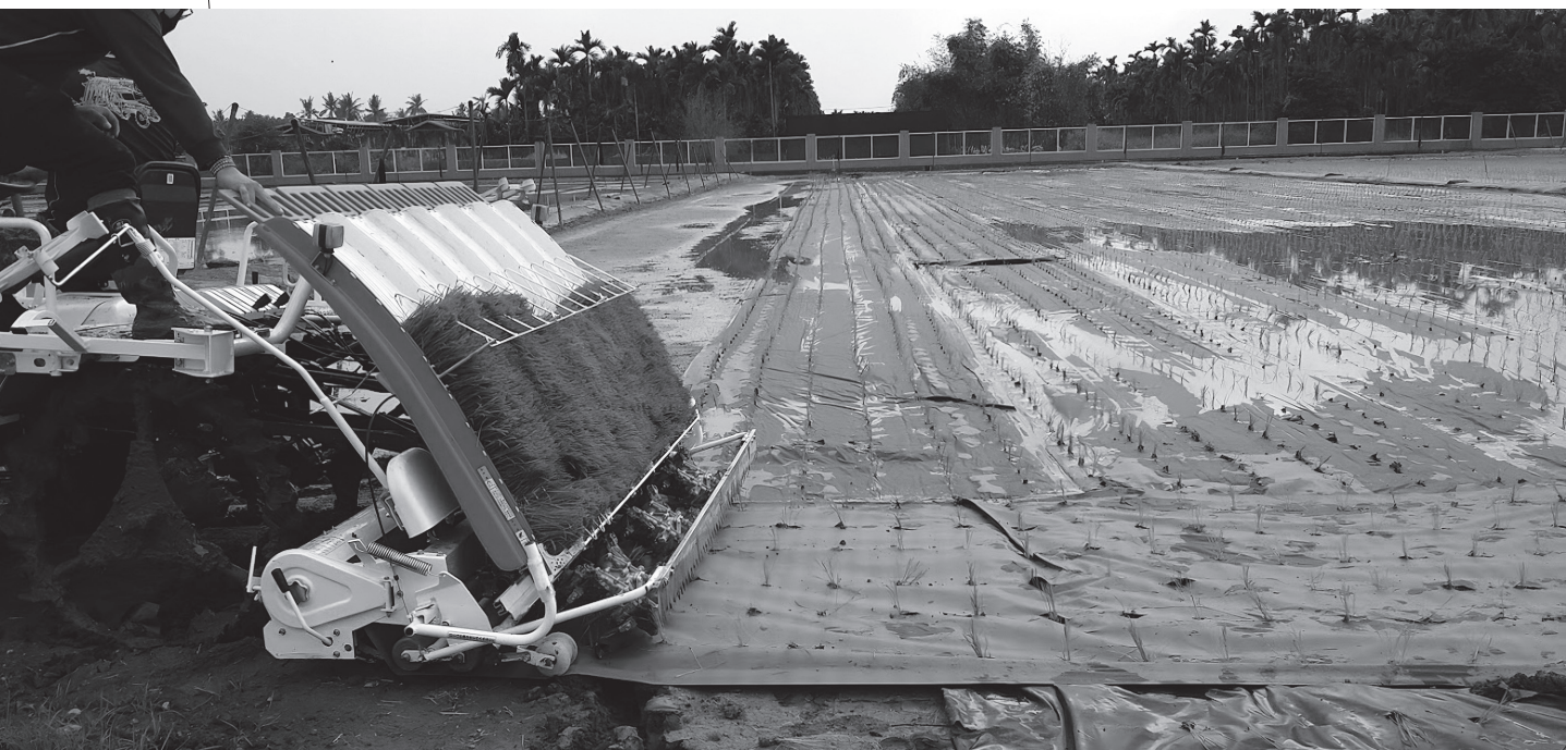
水稻插秧機附掛紙膜鋪設水田，減少用水、防治雜草及減少溫室氣體排放。
