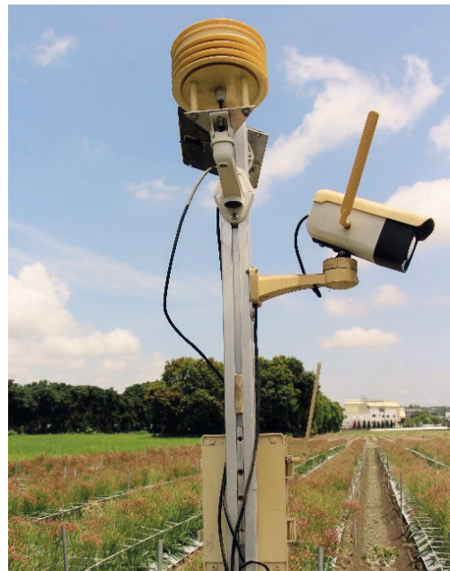
造價親民的微氣候監測器，號稱土裡一插、電池一裝、掃掃 QR 就完成安裝。
