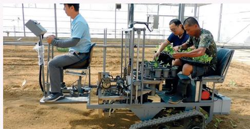
圖2. 履帶式電動移植機作業情形。
