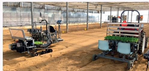
圖7. 桃改場附掛式移植機與現今履帶式電動移植機試驗情形。
