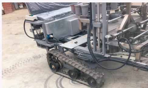
圖3. 本移植機迴轉半徑僅1.8公尺，可直接在水泥地原地迴轉。
