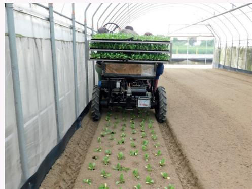
圖6. 桃改場過去開發履帶式電動移植機作業情形。
