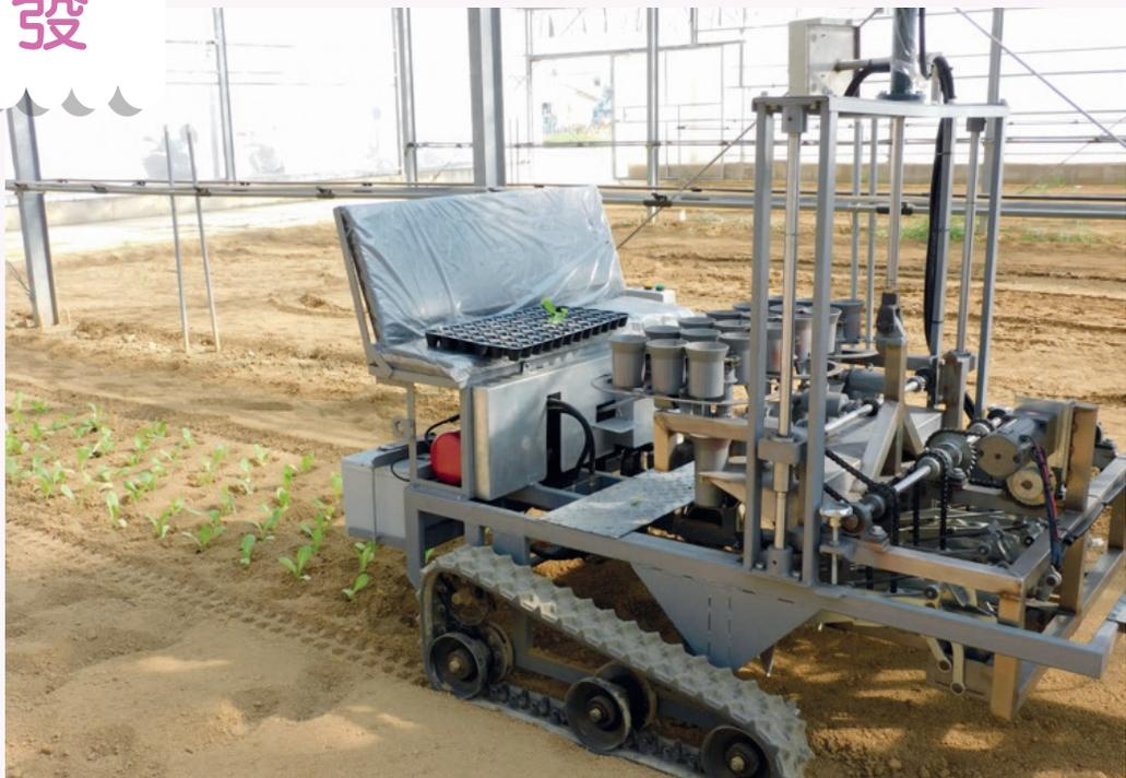
履帶式電動移植機。
