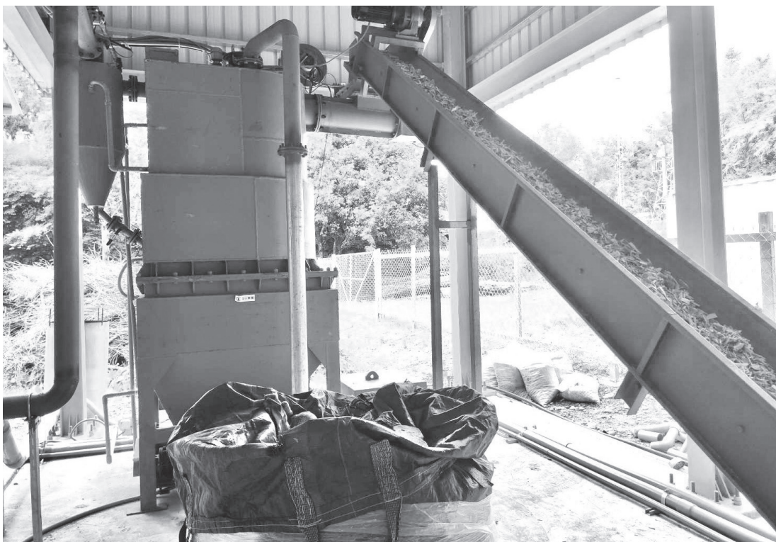
林業及自然保育署臺中分署於梨山工作站設置氣化爐發電設備。
