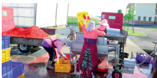
圖3.番茄採種調製作業——以果實破碎機分離主產物種子與副產物果皮果肉。
