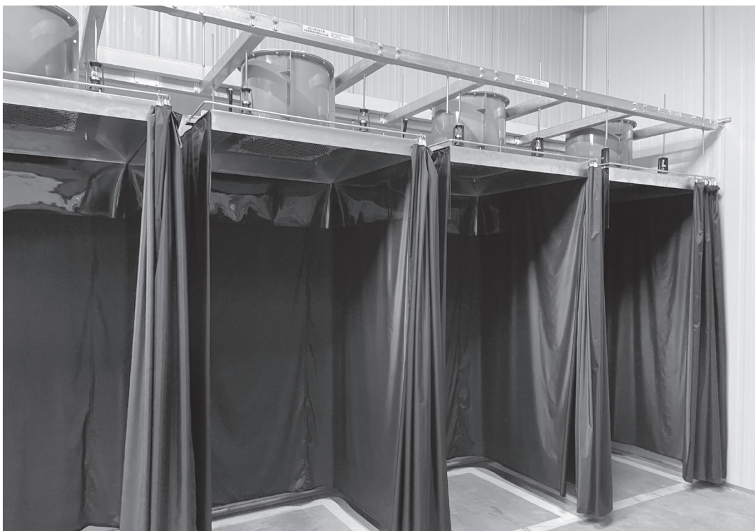
設置頂吸式壓差預冷設備，快速除去果實田間熱延長保鮮期。
