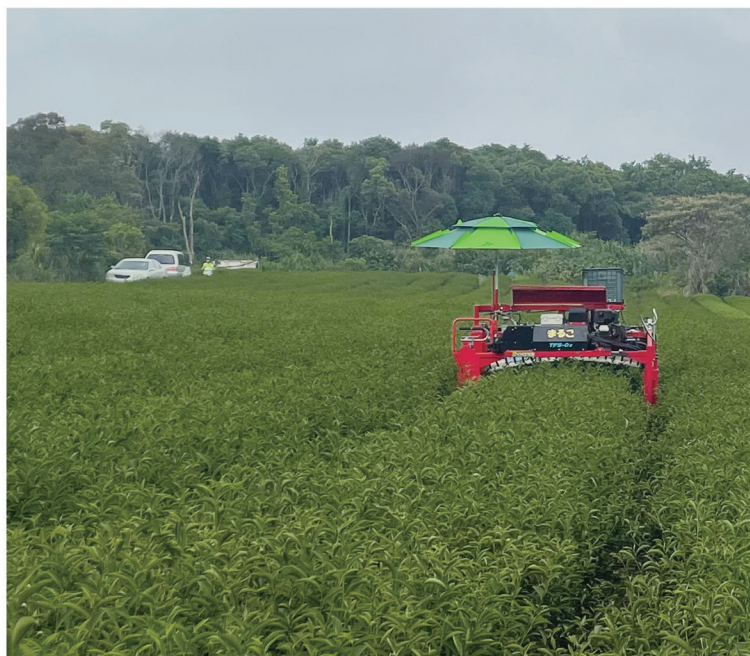
使用全自動茶葉採收機搭配茶葉代耕模式之智慧化管理系統。
