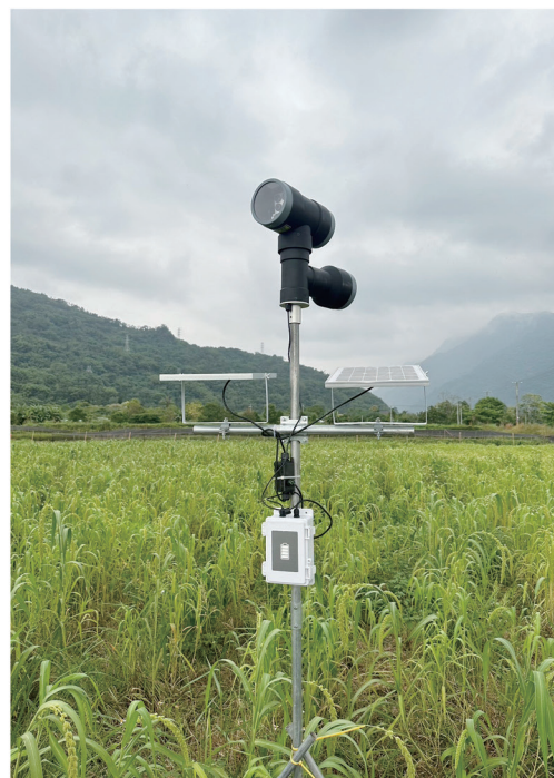
田區架設雷射驅鳥器。
