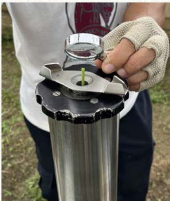
使用氮氣加壓測量葉片水勢。
