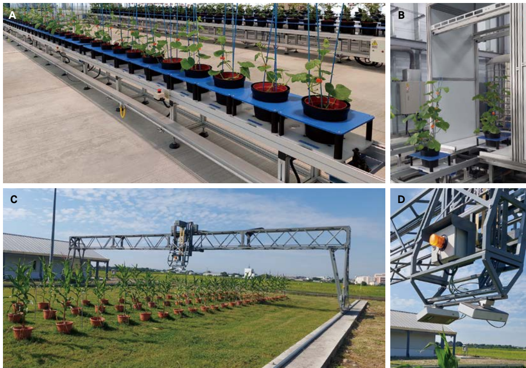
國家植物表型體分析中心溫室內之 (A) 德國 LemnaTec PhenoAlxpert HT 輸送帶系統、(B) 影像分析系統，以及 (C) 荷蘭 Phenospex FieldScan 軌道式系統、(D) 多光譜掃描儀。
