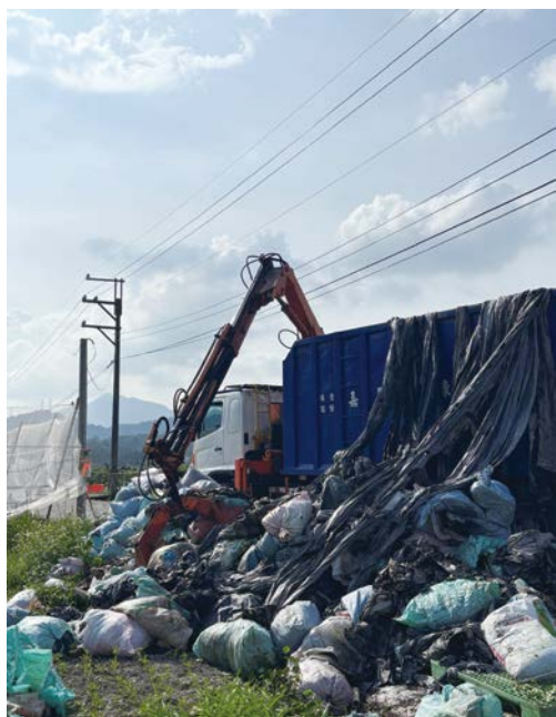
載運車於田間夾取農業塑膠並載運至清洗循環場。
