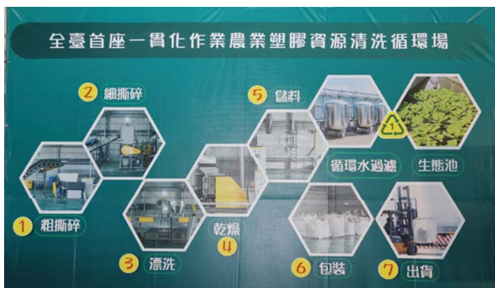
農業部（農糧署）輔導設置之農業塑膠資源清洗循環場作業流程圖。
