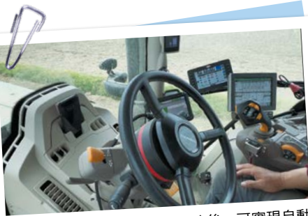
農機整合 RTK 高精度定位服務後，可實現自動駕駛導航。農民在作業期間不需時刻手扶方向盤，能有效緩解長時間農事的疲勞。
