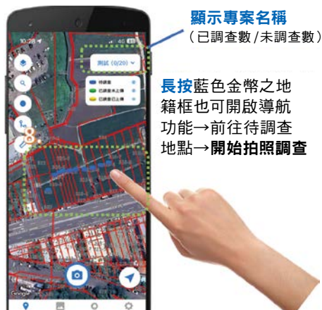
多點勘災調查作業結合導航功能操作示意圖。
