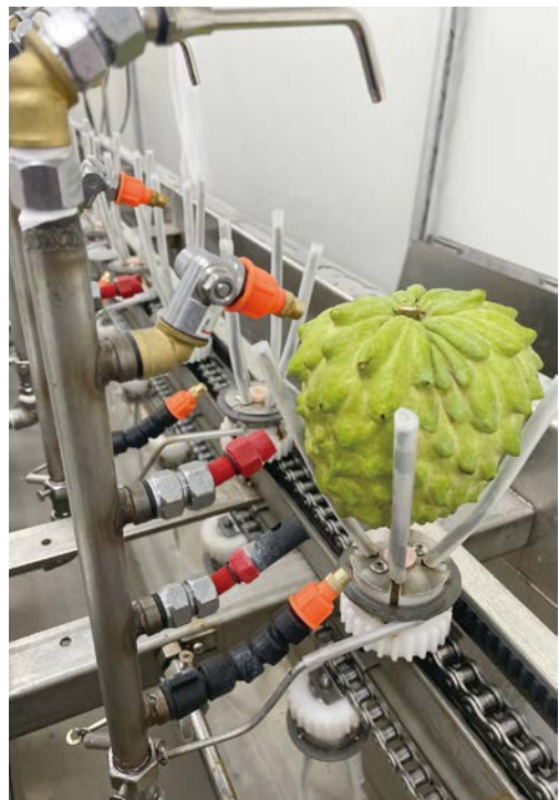
擺動式的高壓空氣吹嘴將果實徹底清潔並吹乾。
