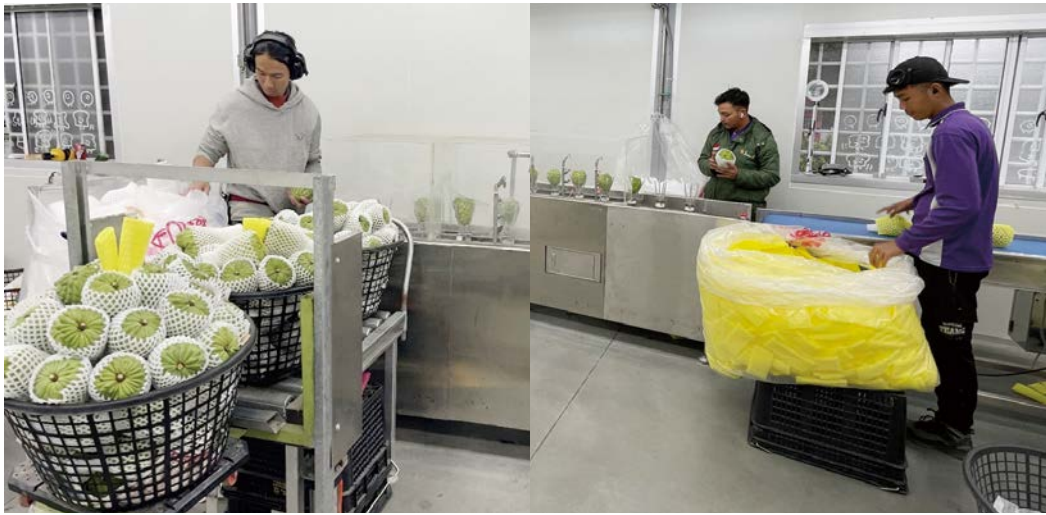
左圖：操作時 1 人將果實自舒果套取出檢查後放入機器。 右圖：機器清潔後，即可套上舒果套準備裝箱。
