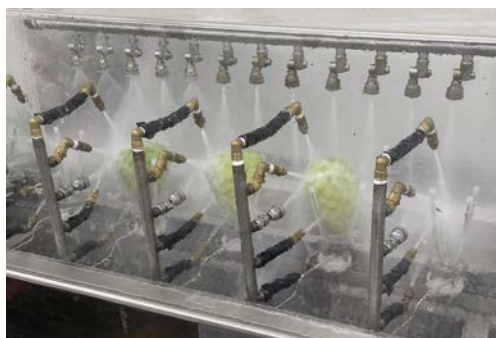
擺動及固定噴頭進行清洗。
