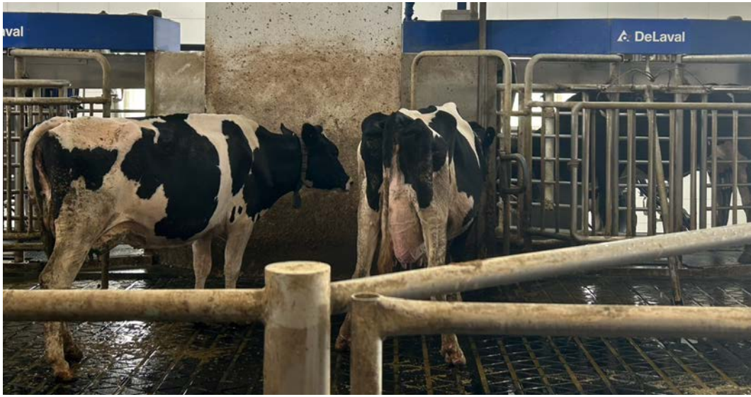
乳牛場導入自動化擠乳系統，可讓乳牛依需求主動進入擠乳站，提升擠乳作業彈性，並透過乳房健康監測及異常預警，強化乳房炎之早期發現與管理。（資料來源：農科院）
